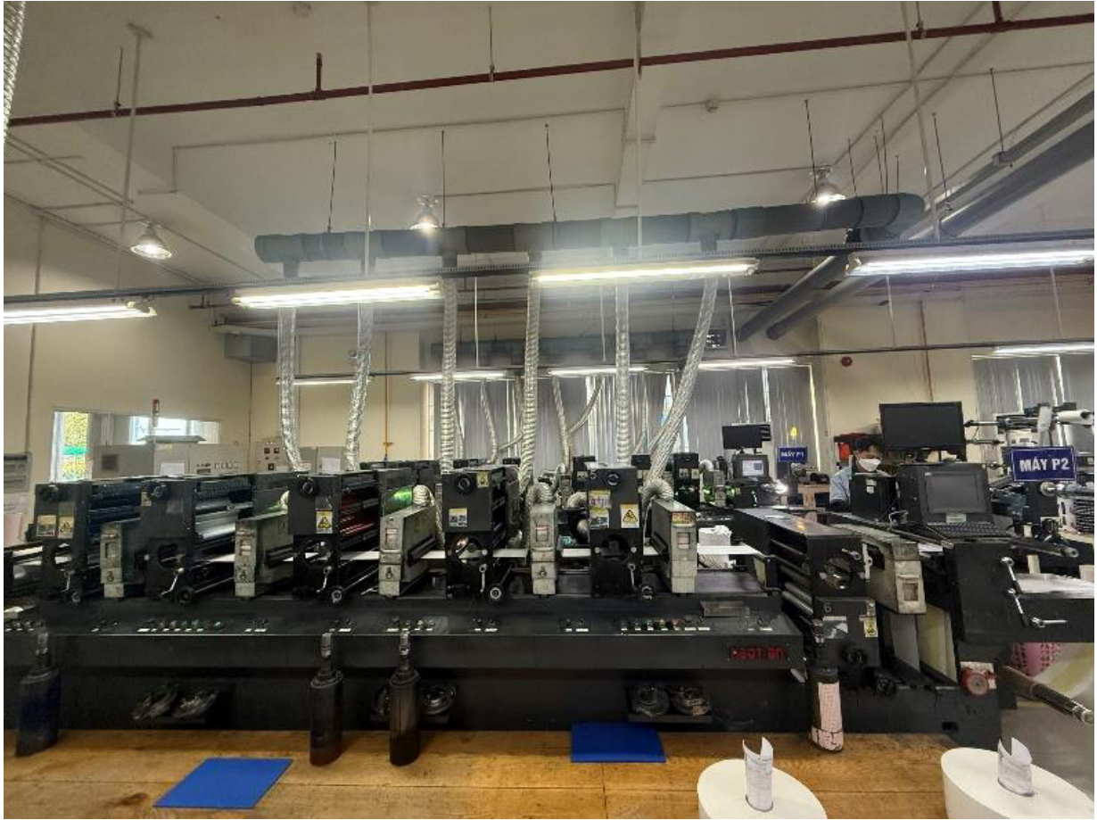
f. Cụm máy in LP 5 màu sản xuất nhãn dán công nghệ Letterpress
