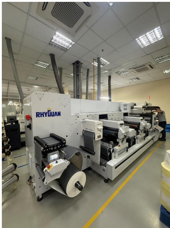
Hình 3.18 Đường ống thu gom khí thải phát sinh từ máy in Flexo
