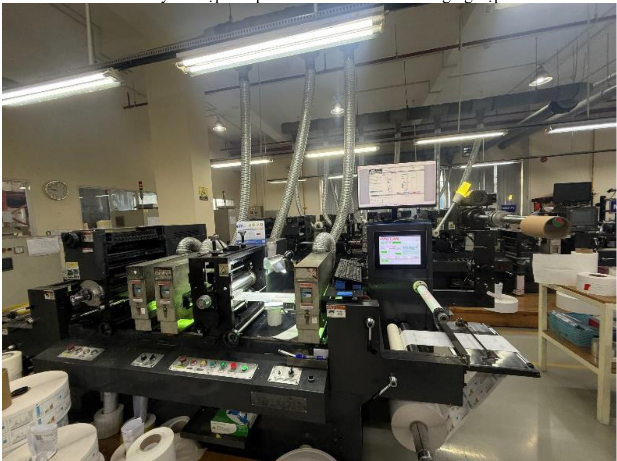
e. Cụm máy in LP 3 màu sản xuất nhãn dán công nghệ Letterpress
