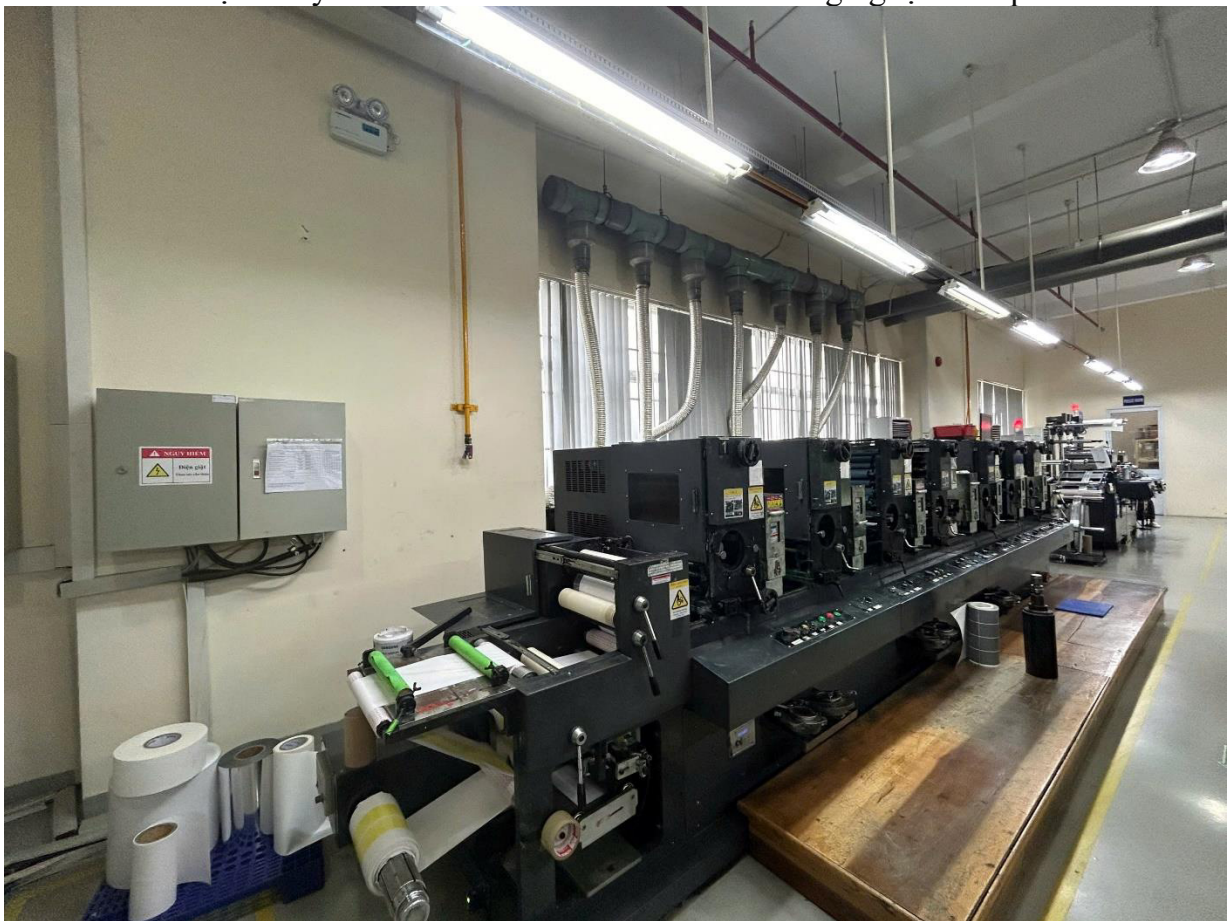
g. Cụm máy in LP 7 màu sản xuất nhãn dán công nghệ Letterpress
